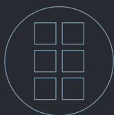
6 x Modul 45® Wymiar zewnętrzny Ø 234 mm
