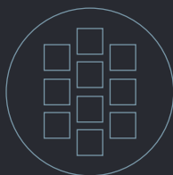
10 x Modul 45® Wymiar zewnętrzny Ø 294 mm
