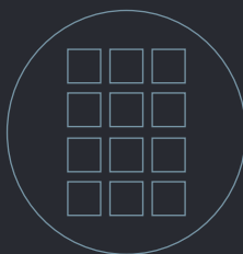
12 x Modul 45® Wymiar zewnętrzny Ø 324 mm
