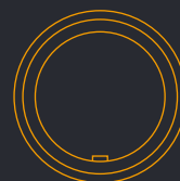
Pokrywa zaślepiająca Wymiar zewnętrzny Ø 140 mm
