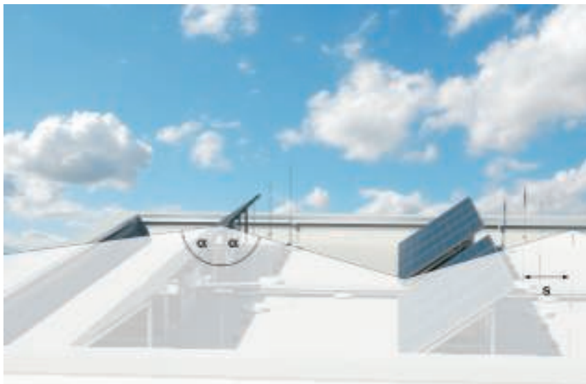
\alpha^\circ = Kąt ochronny, s = Odstęp separacyjny
