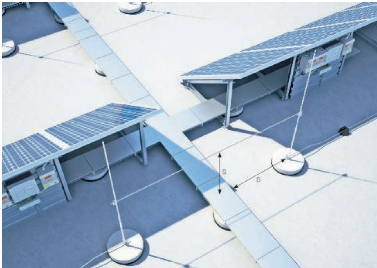
Rysunek 1: Odstęp izolacyjny (s) pomiędzy instalacją odgromową oraz ułożonymi przewodami zasilającymi i sterowania
